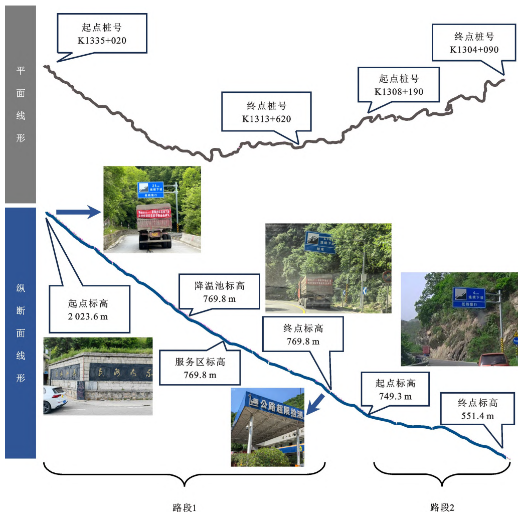
图 1 试验路段平纵线形及设施示意
