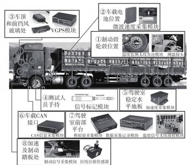
图5 试验仪器安装位置
