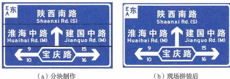
图 19 工厂分块制作现场拼装
