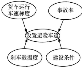
图2 避险车道设置流程
